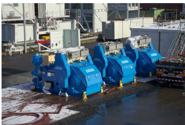
Bild 4: 2200PS Wirth Spülpumpen für die T-150, 'Mittelplate' RWE-Dea/Wintershall
